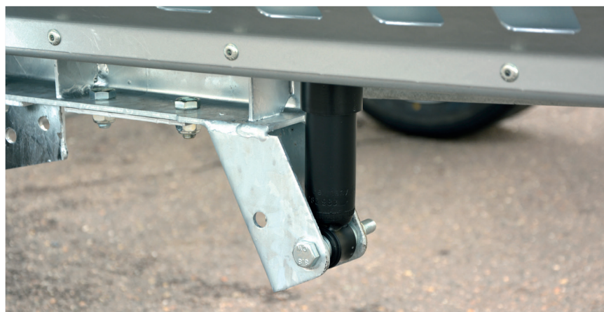
wartungsfreie hydraulische Kippdämpfer bringen Kippbrücke in Schräglage
