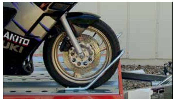
Abbildung: Vorderrad soweit vorfahren, bis sich der Lenker nicht mehr bewegen lässt.
